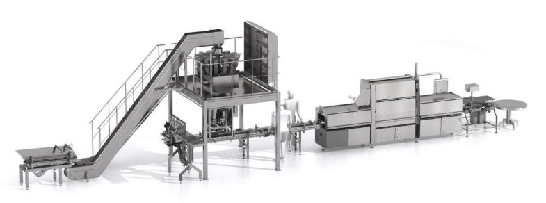
1) Storage hopper 3) Product guide 5) Tray denester 7) Manual styling conveyor 9) Check weigher 11) Buffer table 2) Infeed conveyor 4) Multihead weigher 6) Distribution tool 8) Tray sealer 10) Metal detector 12) Washing station
